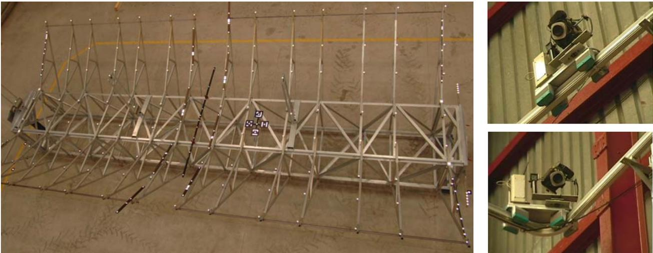
**Bild 1: Kollektorstruktur mit Zielmarken bei der 3d-Messung (links).
