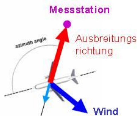
Abb. 10: Horizontalwinkel zwischen Wind, Flugzeug und Messstation. Der hellblaue Pfeil deutet die Windkomponente in Schallausbreitungsrichtung u an.
