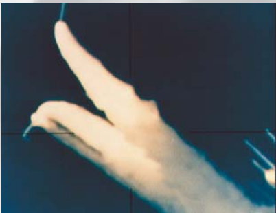
STS-51L-Untersuchungsfoto bei 76,425 Sekunden: Die Nasenkappe des rechten Feststoffboosters hat sich geöffnet und den Bremsfallschirm entlassen.
