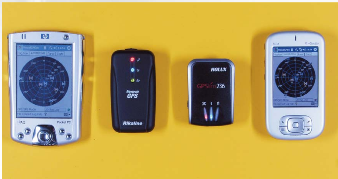
Die Rikaline R 6033 und die Holux GR-236 sind beide hochempfindliche und schnelle GPS-Empfanger, die die errechneten Positionsdaten drahtlos an ein Handy, einen PDA oder einen PC weitergeben konnen. Hier werden bei schlechtem Wetter noch 2 m hinter einem Fenster jeweils 3 GPS-Satelliten ausgewertet. Foto: Hartmut E. Sanger.
