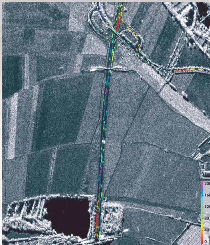
Das Bild zeigt Ergebnisse, wie sie die Deutsche TerraSAR-X Mission liefern kann. Die Farbe der Punkte stellt die Geschwindigkeit der Wagen auf der Autobahn nahe Ludwigshafen dar. Grafik und Fotos: DFD/DLR.
