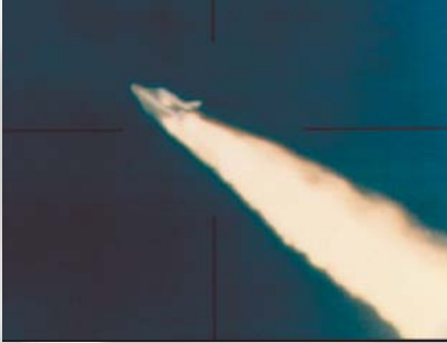
STS-51L-Untersuchungsfoto bei 73,201 Sekunden: Aufblitzen zwischen Orbiter und Externem Tank (ET).
