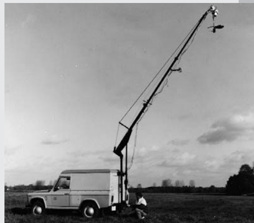
Mobiles Bodenmesslabor des MdZ-Fernerkundung zur synchronen Messung spektraler Objektsignaturen im optischen, mittleren Infrarot- und Mikrowellenbereich (Faltmast mit Radiometern in Arbeitsstellung).
