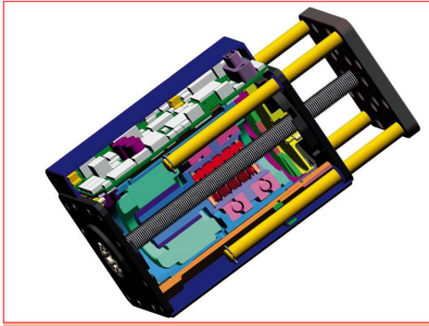
Mechatronischer Linearaktuator auf Basis der Planetenwältzgewindespindel ■
