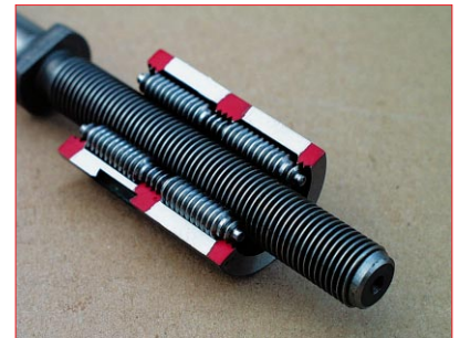
Die Planetenwältzgewindespindel als Kernstück neuartiger mechatronischer Bremsen für Schienenfahrzeuge hat eine konkurrenzlos hohe Lebensdauer ■
