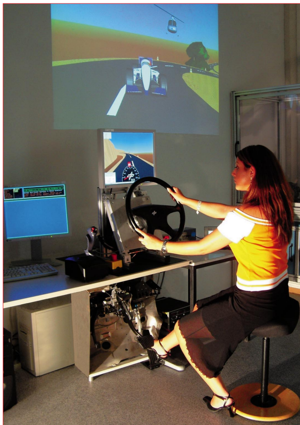
MechatronicCarLab mit kraftreflektierenden Lenkeingabegeräten (Lenkrad, Joystick) und kraftreflektierendem Gaspedal, Echtzeit-Fahrdynamiksimulation und -visualisierung ■
