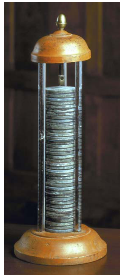
▲ Gambar 30. Voltaic Pile
