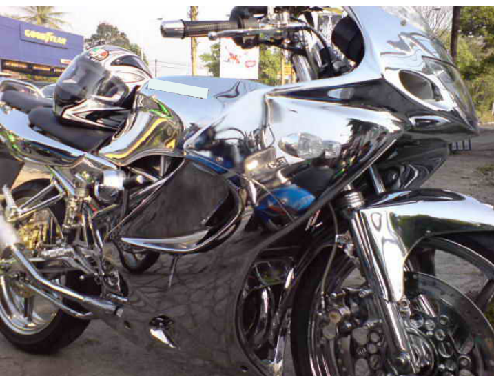
▲ Gambar 37. Motor yang telah diverkrom
