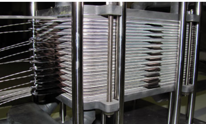
▲ Gambar 22. Susunan Sel SOFC
