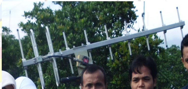
Gambar 3 : Fisik antenna Yagi Frekuensi 400 MHz – 405 MHz
