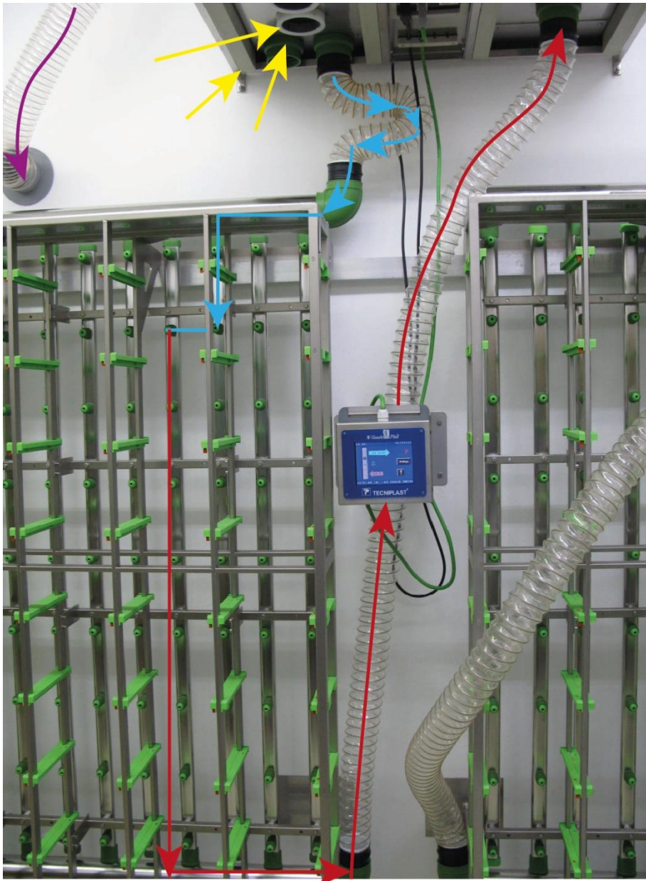
Abbildung 5: Luftstrom im IVC System,
