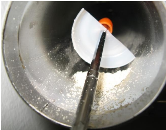
Abbildung 7: Abluftstaubgewinnung aus dem unteren Abluftrohr mit dem Staubkratzer
