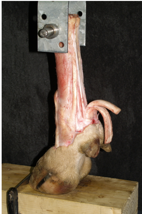
Abbildung 5: Darstellung des Versuchsaufbaus mit einem für den Belastungsversuch präparierten und in die Zwick Z010-Maschine eingespannten Rinderfuß während der Belastung (Strukturen sind in Abbildung 6 beschriftet.)
