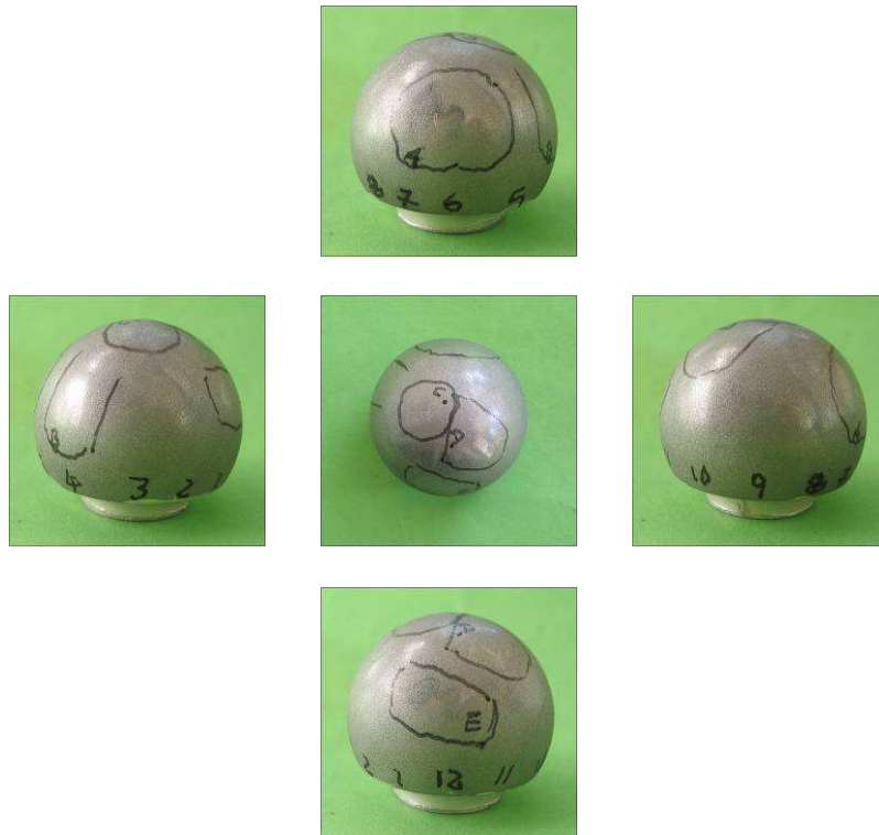
Abbildung 31: Versuch 1.1. - Beurteilung des Kopfabriebs: Detailansicht
