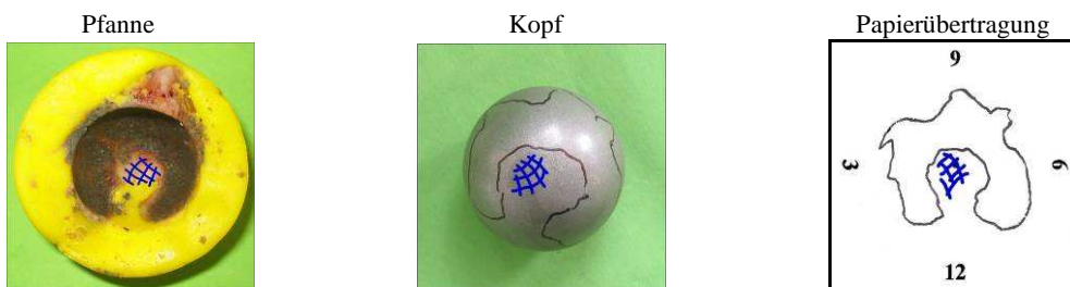
Abbildung 30: Versuch 1.2 - Beurteilung des Kopfabriebs mittels makroskopischer Begutachtung
