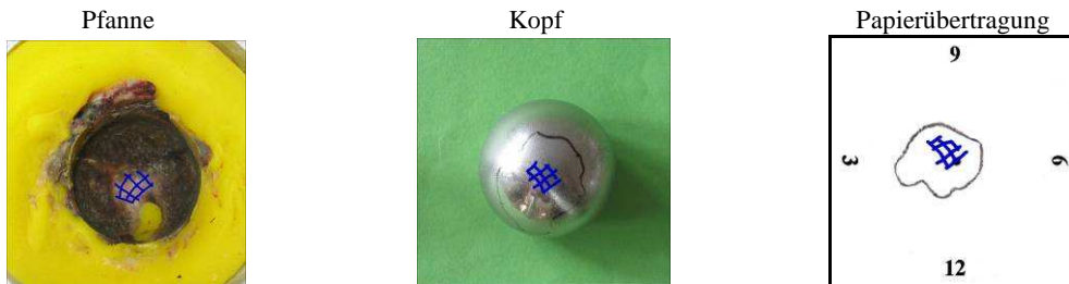
Abbildung 44: Versuch 3.3 - Beurteilung des Kopfabriebs mittels makroskopischer Begutachtung
