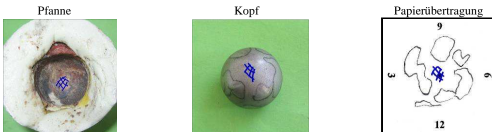
Abbildung 36: Versuch 2.1 - Beurteilung des Kopfabriebs mittels makroskopischer Begutachtung
