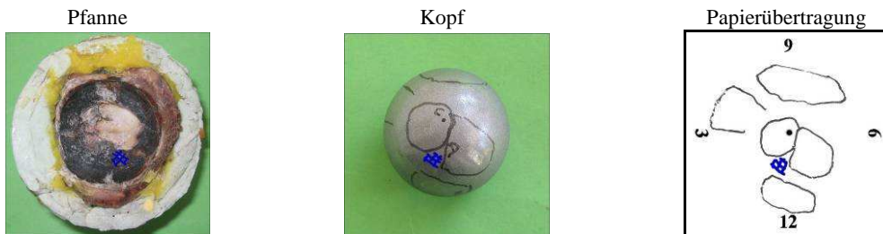
Abbildung 29: Versuch 1.1 - Beurteilung des Kopfabriebs mittels makroskopischer Begutachtung
