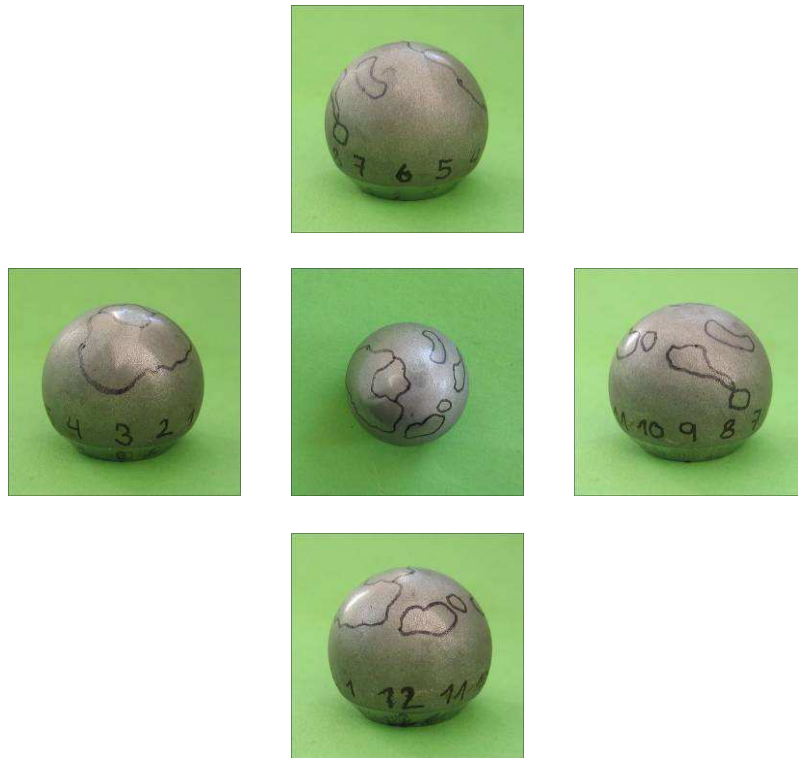
Abbildung 40: Versuch 2.2 - Beurteilung des Kopfabriebs: Detailansicht
