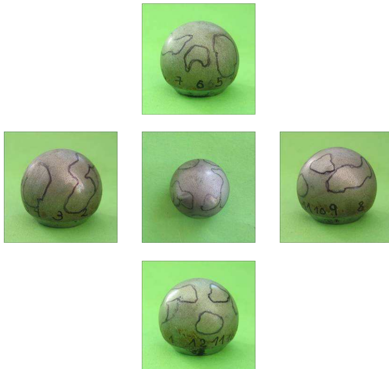
Abbildung 39: Versuch 2.1 - Beurteilung des Kopfabriebs: Detailansicht
