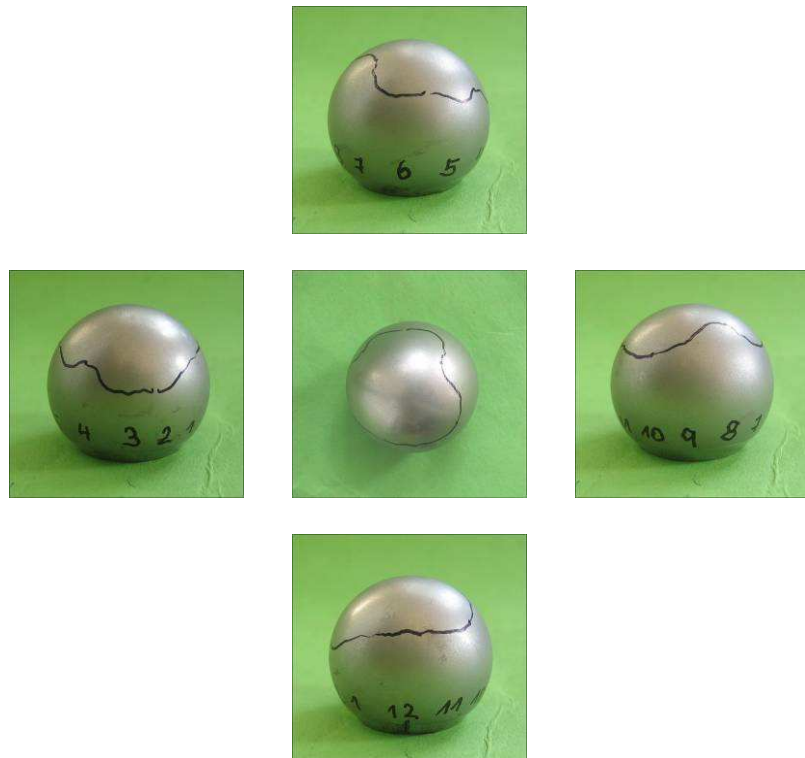
Abbildung 46: Versuch 3.1 - Beurteilung des Kopfabriebs: Detailansicht
