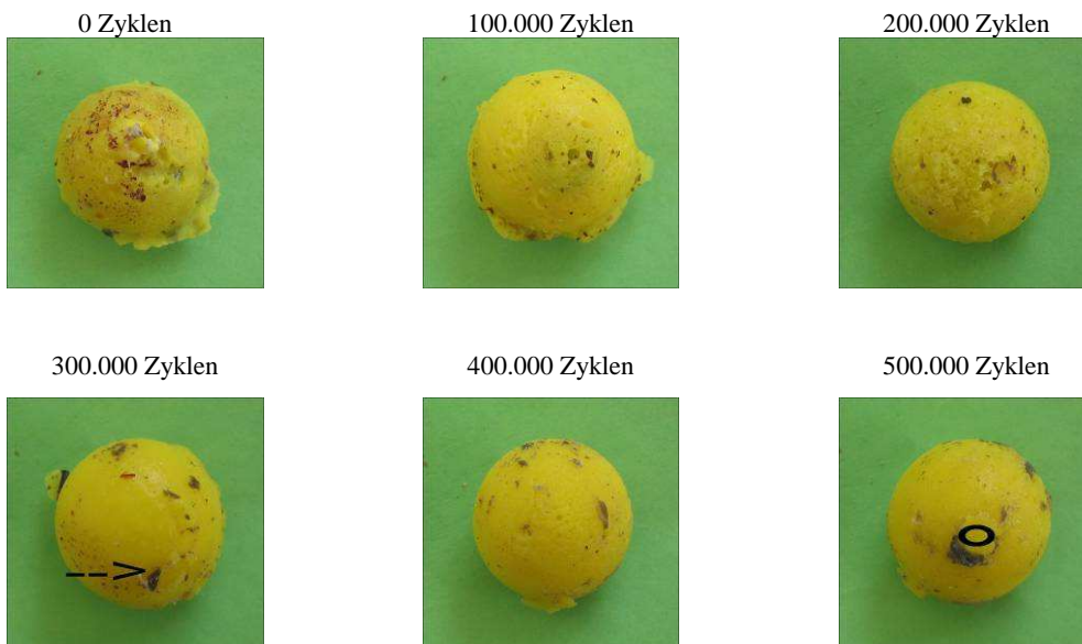
Abbildung 34: Versuch 2.2 - Beurteilung des Abriebverhaltens am Acetabulum mit Hilfe von Negativabdrücken
