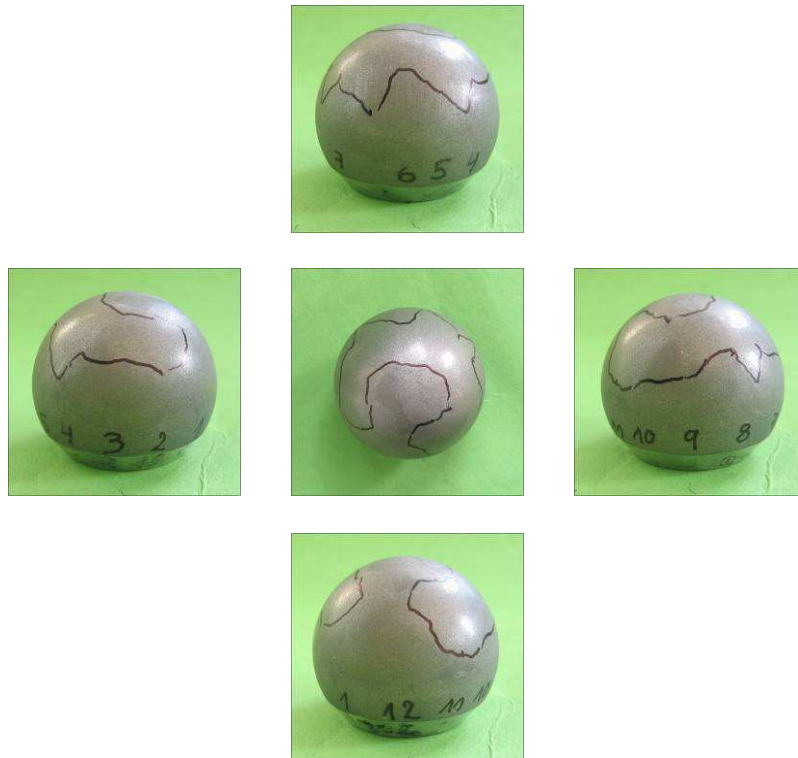
Abbildung 32: Versuch 1.2 - Beurteilung des Kopfabriebs: Detailansicht
