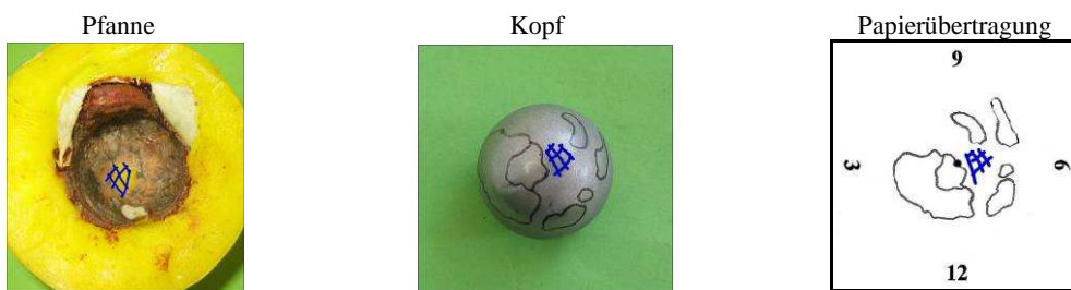
Abbildung 37: Versuch 2.2 - Beurteilung des Kopfabriebs mittels makroskopischer Begutachtung
