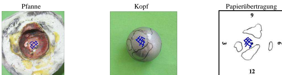
Abbildung 38: Versuch 2.3 - Beurteilung des Kopfabriebs mittels makroskopischer Begutachtung
