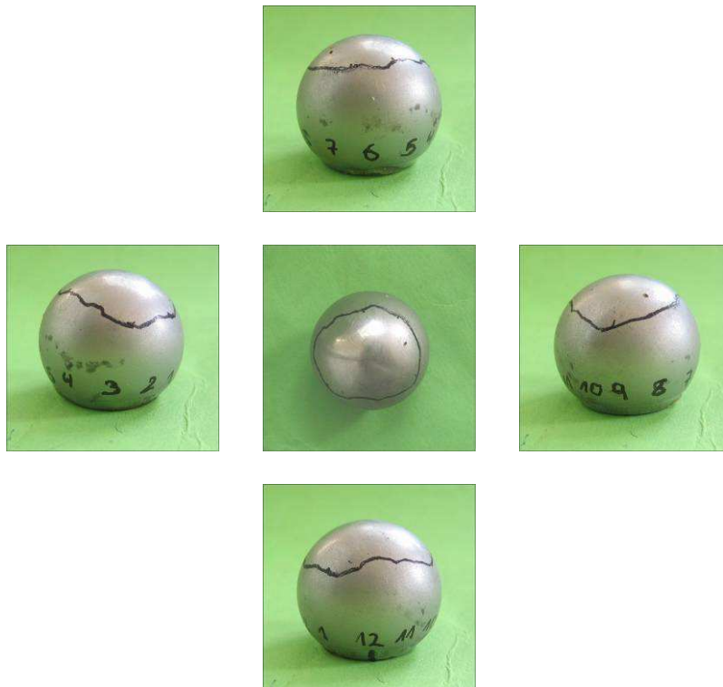
Abbildung 47: Versuch 3.2 - Beurteilung des Kopfabriebs: Detailansicht
