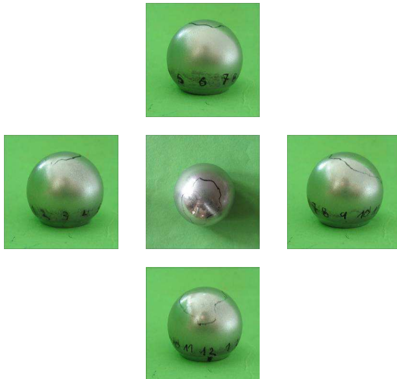
Abbildung 48: Versuch 3.3 - Beurteilung des Kopfabriebs: Detailansicht
