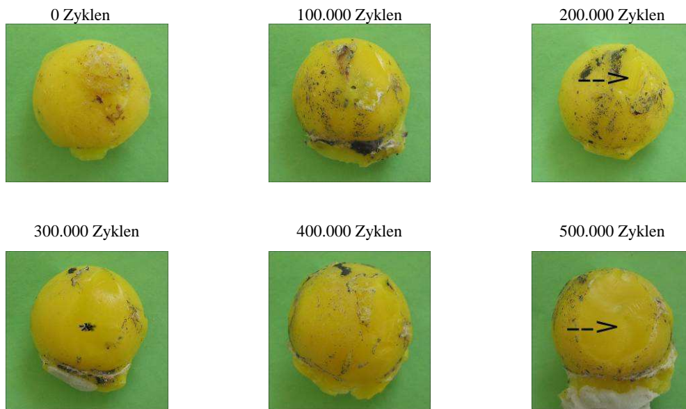
Abbildung 27: Versuch 1.1 - Beurteilung des Abriebverhaltens am Acetabulum mit Hilfe von Negativabdrücken
