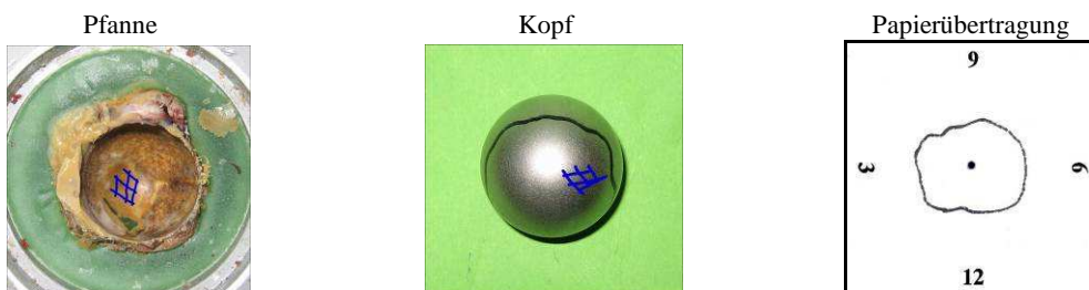
Abbildung 45: Versuch 3.4 - Beurteilung des Kopfabriebs mittels makroskopischer Begutachtung
