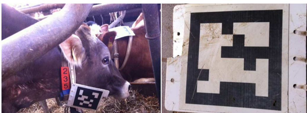
Abbildung 23: Marker auf Polystyrolplatte, Variante 2. Die Bilder zeigen einen verrutschten und einen abgefallenen Marker. Ursache hierfür waren die durch hohe mechanische Beanspruchung ausgerissenen Bohrlöcher.
