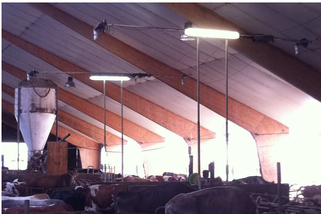
Abbildung 25: Beleuchtung der Versuchsfäche. Das Bild zeigt zwei Kameratürme mit vier eingeschalteten Neonlampen. Durch die seitlich an den Türmen angebrachten Lampen wurde eine gleichmäßige Ausleuchtung ohne punktförmige Überstrahlungen erzielt.
