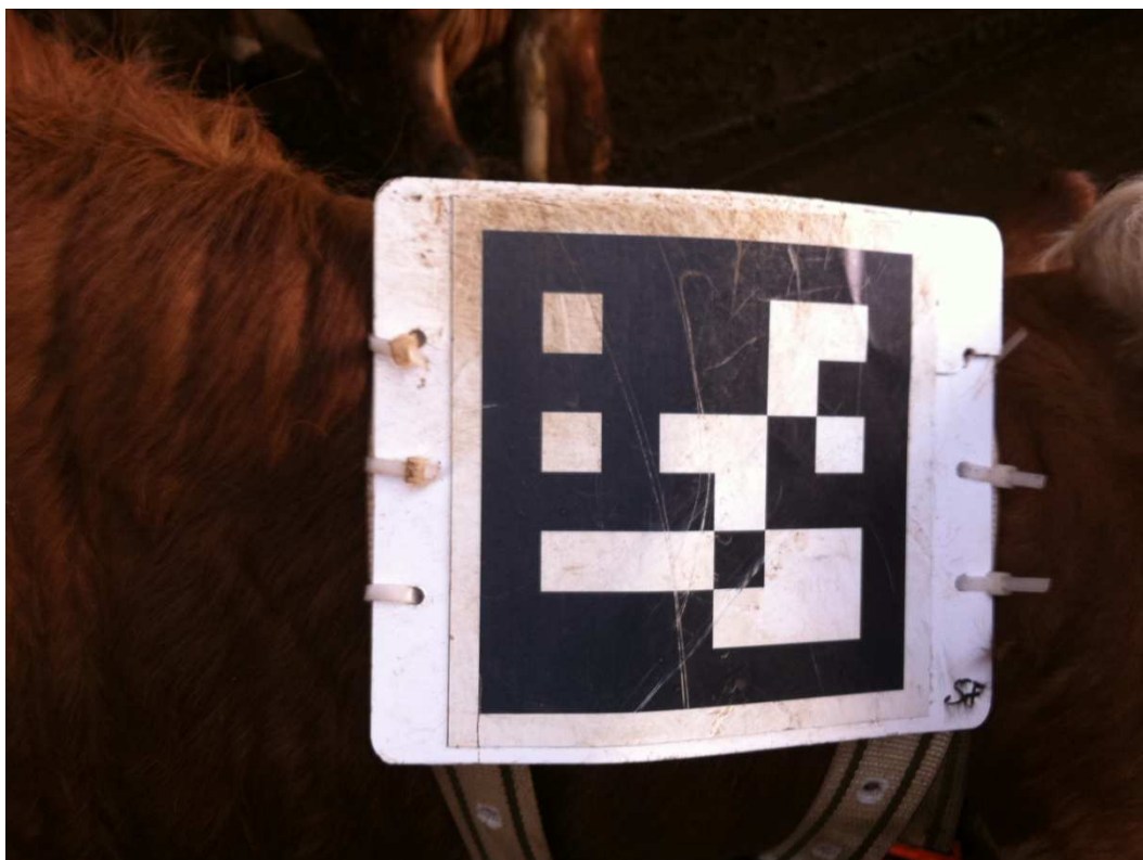
Abbildung 22: Marker auf Polystyrolplatte, Variante 2. Die mit Bohrungen versehene Platte ist über Kabelbinder an zwei getrennten Halsbändern befestigt. Rechts oben ist ein ausgerissenes Bohrloch zu erkennen.
