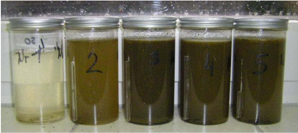
Abbildung 2: Veränderung des Waschwassers während einer Melkzeit: Die Proben wurden nach 0, 10, 20, 40 und 80 Kühen genommen
