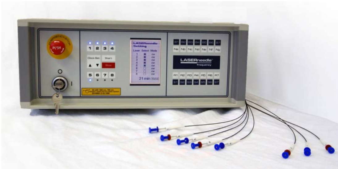
Abbildung 4.3: LASERneedle® Gerät der Firma Ronbar AG mit fünf aktivierten Lasernadeln.
