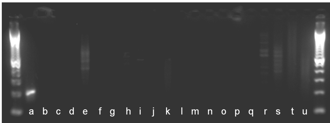
Abb. 38: 1 Agarose Gel-Elektrophorese nach cPCR im Rahmen der Spezifitätsbestimmung an Tag 5: Alle 20 Strongyloides -negativen Proben (b-u) zeigen im Gegensatz zu SS 1 keine charakteristische Bande.
