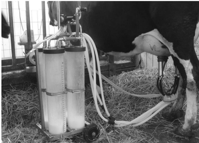
**Abbildung 3: Vierviertelmelkmaschine mit angesetztem Melkzeug**
