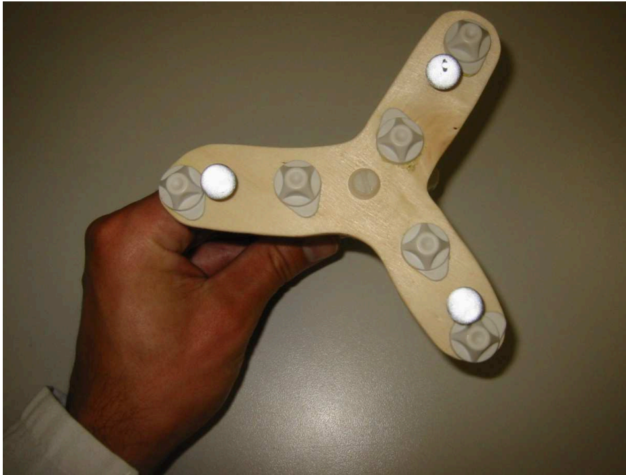
Abbildung 6: Prototyp des Referenzsterns aus Sperrholz
