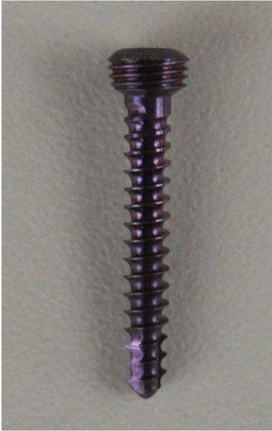
Abbildung 38: 2,7mm kopfgewindetragende Schraube, doppelgängiges Kopfgewinde mit gleicher Steigung wie am Schaft
