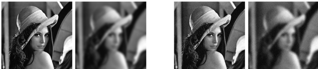
Abbildung 25: Links: Fokussierte und defokussierte Darstellung des Lena-Testbildes aus dem simulierten rauschfreien Bildstapel. Rechts: Fokussierte und defokussierte Darstellung des Lena-Testbildes aus dem simulierten Stapel mit Rauschen Gaußscher Verteilung.
