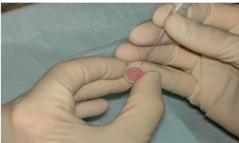
Abb. 6 Einführen der Sauerstoffmesssonde in die besiedelte Leitschiene unter Verwendung der Hilfsbohrung im angefertigten Polykarbonatring
