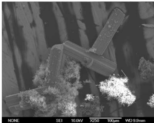
Abbildung 11-2: Aufnahme von quaderförmigen Kristallen der Verbindung SrAlSi 4 N 7 unter dem Rasterelektronenmikroskop.
