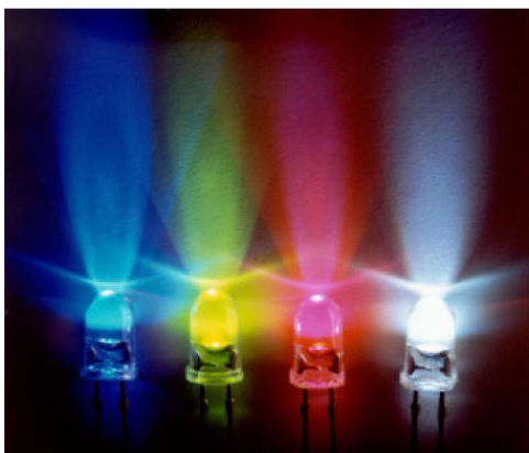
Abbildung 2: (In,Ga)N-Halbleiter-Dioden mit unterschiedlichen Farbkonvertern. [17]
