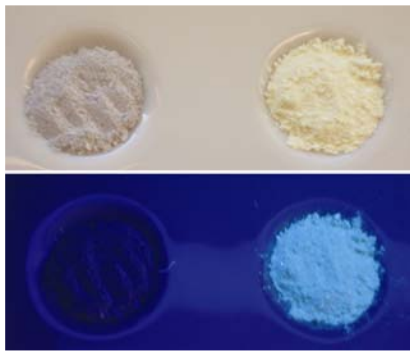
Abbildung 9-10: Photographie der undotierten (jeweils links) sowie der mit 4 % \text{Eu}^{2+} dotierten Verbindung \text{Ba}_3\text{Si}_6\text{O}_9\text{N}_4 unter Tageslicht (oben) und UV-Bestrahlung ( \lambda = 254 und 366 nm; unten).
