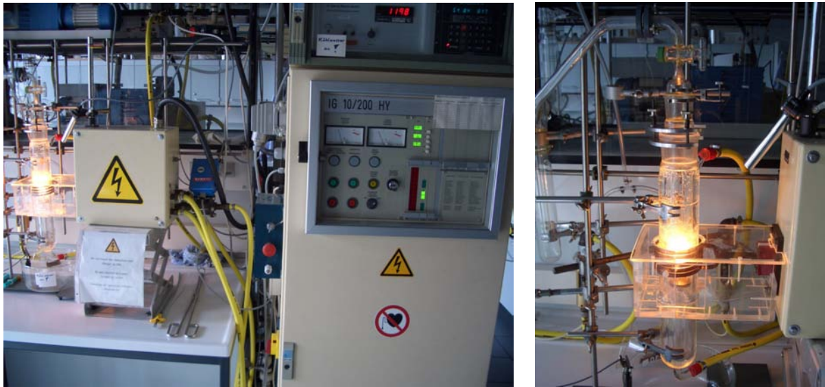
Abbildung 1-3: Links: HF-Anlage mit Hochfrequenzgenerator, Außenschwingkreis und Induktionsspule mit glühendem Tiegel. Rechts: Vergrößerte Aufnahme des Reaktors bei Tiegelttemperaturen von etwa 1600 °C.
