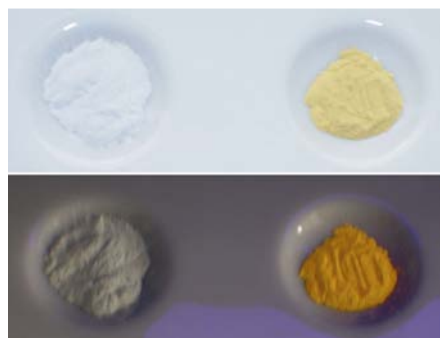
Abbildung 7-10: Fotografie von phasenreinem, farblosem Ba_{1.8}Ca_{2.2}Si_6N_{10}O (jeweils links) und von Ba_{1.8}Ca_{2.2}Si_6N_{10}O:Eu(1\%) (jeweils rechts) unter Tageslicht (oben) und unter UV-Bestrahlung ( \lambda = 254 + 366 nm, unten).
