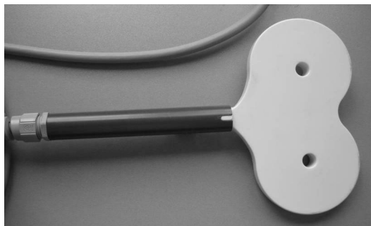
Abbildung 3.16: Am Hund zur peripheren Magnetstimulation verwendete Achterspule.
