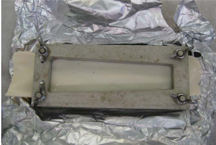
*Abbildung 6: Zur Zelldissoziation wurden die Aortensegmente mit nach oben gerichtetem Endothel in Aluminiumblöcke eingespannt.*
