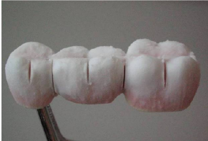
Abb. 32: Aufbrennkeramik geschichtet mit Entlastungen zur Kompensation der Schrumpfungsspannungen
