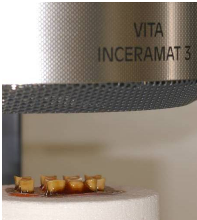
Abb. 30: Brücken direkt nach der Infiltration
