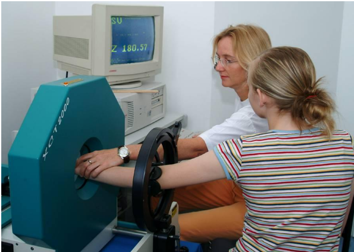
Abb.19: Durchführung einer pQCT-Messung am Unterarm.
