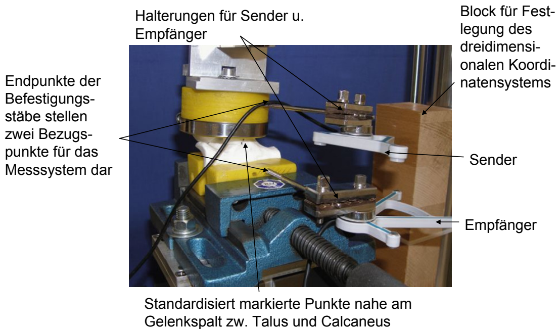
Abbildung 9: Zebris – Messsystem im Versuchsaufbau
