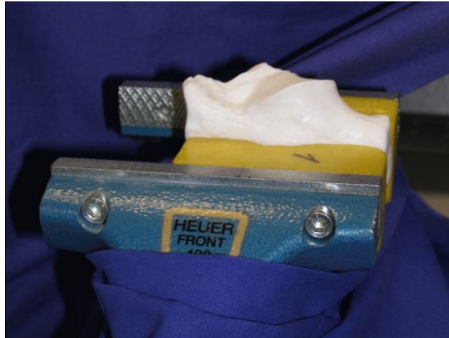
Abbildung 20: Calcaneus mit Einspannung in Seitenansicht
