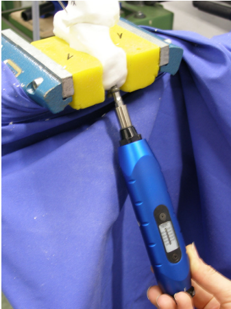
Abbildung 33: USG mit Anzugsdrehmoment der Schrauben von 5Nm (1)
