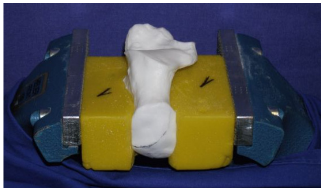
Abbildung 19: Calcaneus in Epoxidharzform im Schraubstock
