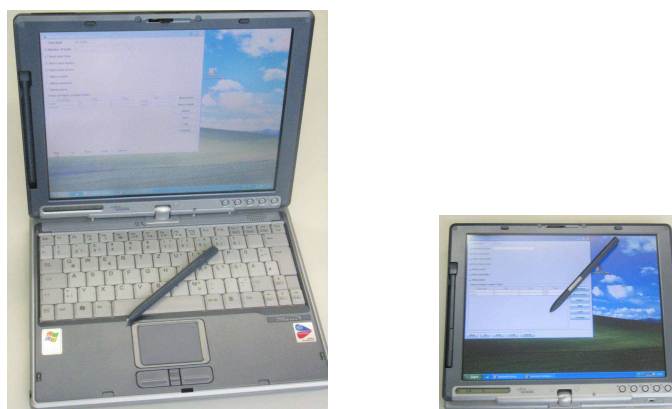
Abbildung 9: Tablet PC von Fijutsu Siemens (Lifebook T3010). Der Bildschirm lässt sich um 180 Grad drehen und umklappen. Die Scheiben/Kugeln können mit dem speziellen Stift auf dem Bildschirm berührt und versetzt werden.
