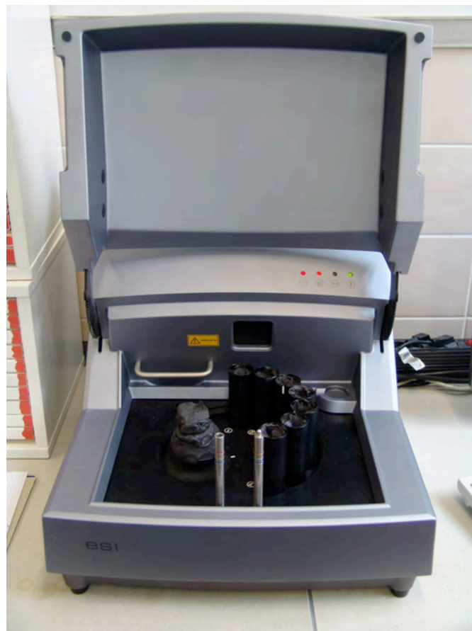
Abb. 16: Der geöffnete Laserscanner „es1“ (Etkon)
