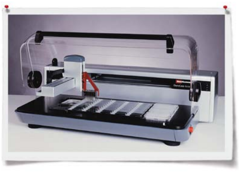
Abb. 3: Microarray-Spotter: Spotting Machine OmniGrid® Accent der Firma GeneMachines® (Bild gemäß http://www.genemachines.com/ ).
