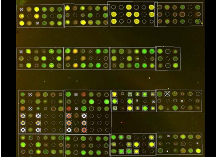
Abb. 9: Microarray-Ausschnitt mit GAL-File: Erkennung der Spots des cDNA-Microarrays mit Hilfe des GAL-Files durch spotspezifische Anpassung und maßgerechte Analyse.
