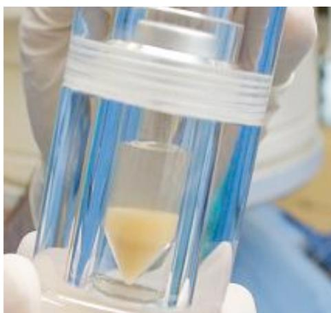
**Abbildung 12: Harz-Mikrosphären in Acrylbehälter**
