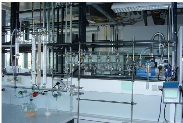
Abbildung 2-1: Kombinierte Vollglas-Vakuum-Schutzgasanlage
