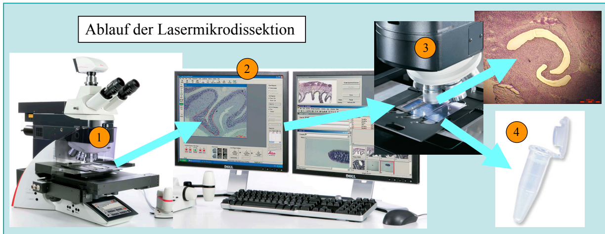
Abbildung 3.2: Ablauf der Lasermikrodissektion: Auf dem mit einem Probenstisch und einem Laser ausgestatteten Mikroskop (1) kann mit der Steuerungssoftware auf dem Bildschirm der Zielbereich ausgewählt werden (2). Anschließend wird dieser durch einen hochfrequenten Diodenlaser ausgeschnitten (3) und fällt zur weiteren Bearbeitung in das darunter liegende Gefäß (4).
