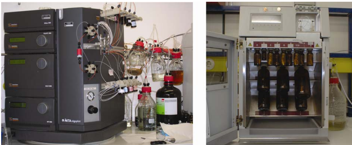
Abbildung 14: Die beiden zur Synthese der DNA Stränge verwendeten Syntheseeinheiten, der Äkta Oligopilot 10 (links) und der Expedite 8900 (rechts).
