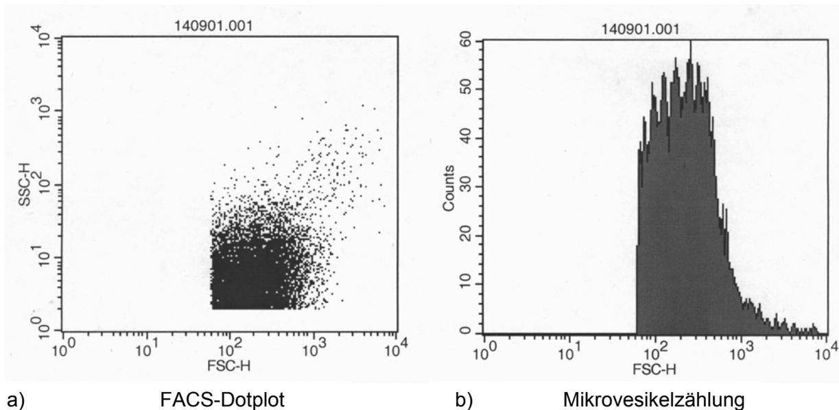
**Abb. 5:** a) Größe (FSC = forwardscatter) und Granularität (SSC = sidewardscatter) sowie b) die Zahl der in vitro hergestellten Mikrovesikel wurden mit Hilfe der Flowcytometrie überprüft. Repräsentatives Ergebnis einer Untersuchung von in vitro hergestellten Plättchenmikrovesikeln.
