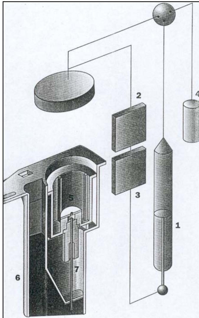
**Abb 7:** Mechanismus des Platelet Function Analyzer (1) Motorbetriebene Spritze, (2) Drucktransducer, (3) Mikroprozessor, (4) Startlösung zur Befeuchtung der Membran, (5) Membran mit zentraler Öffnung, (6) Reservoir, (7) Kapillare, (Bedienungsanleitung für PFA 100).
