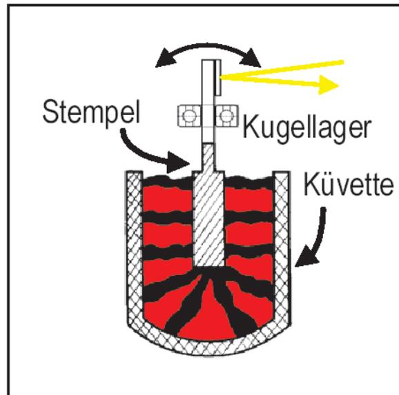
**Abb. 6a:** Schema des thrombelastographischen Messprinzips: Ein an einer kugellagerten Achse befestigter Stempel (Pfeil) wird in eine blutgefüllte Küvette (Pfeil) getaucht und führt eine langsame Rotationsbewegung aus. Die Rotationsbewegung wird mittels einer Lichtquelle (gelber Pfeil) und einem Spiegel erfasst (nach Calatzis, 1996).
