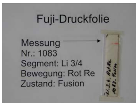
Abb.19: a) Beispiel einer FUJI-Druckmessfolie®, b) Versuchsanordnung mit FUJI-Druckmessfolien®
