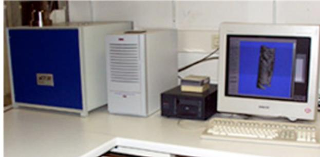
Abb. 4.1: Mikro-Computertomograph Scanco 20 ([www.scanco.ch](http://www.scanco.ch))
