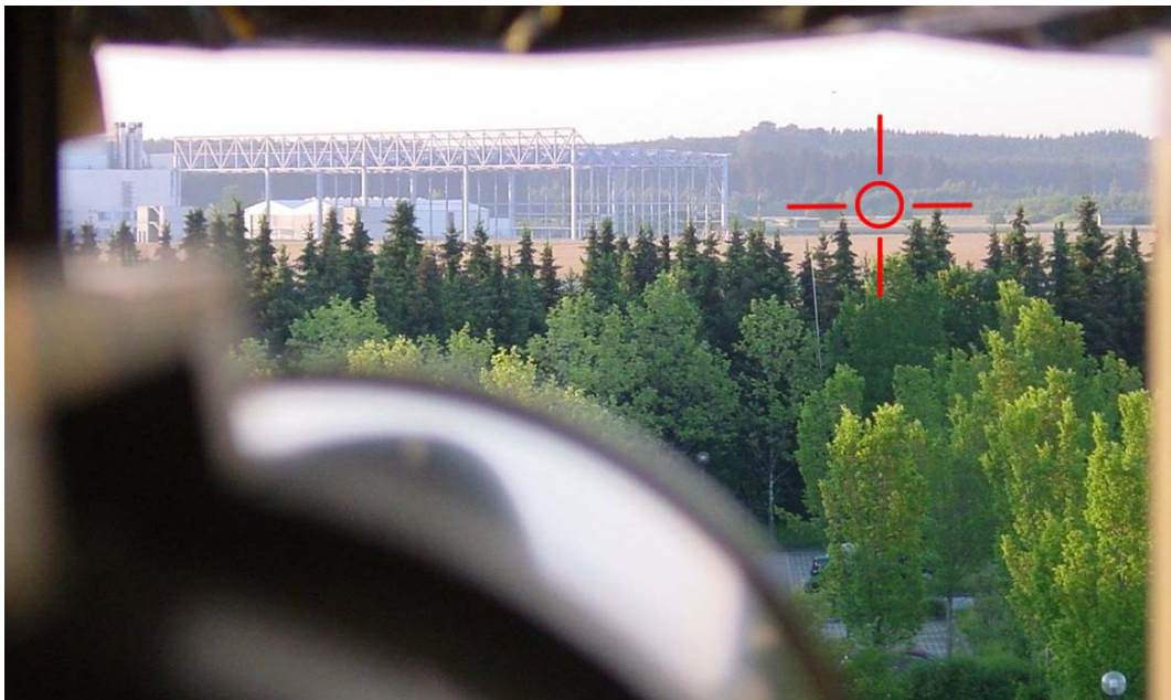
Abbildung 10: Sicht entlang der Messstrecke über das Empfangsteleskop zur Baumgruppe, die als Hard-Target diente
