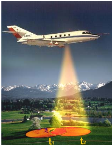
Abbildung 2.13: Illustration eines sehr kleinen Überlappens der Flächen, die bei einer IPDA-Messung von den Online- ( t_1 ) und Offline-Laserimpulsen ( t_2 ) beleuchtet werden; zudem liegt ein strukturierter Boden vor
