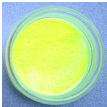
Abbildung 5-19: Fotografie einer mit 3.0 % \text{Eu}^{2+} dotierten Probe von \text{Sr}[\text{Si}_2\text{O}_2\text{N}_2]:\text{Eu}^{2+} ; aufgenommen unter einer UV-Lampe.
