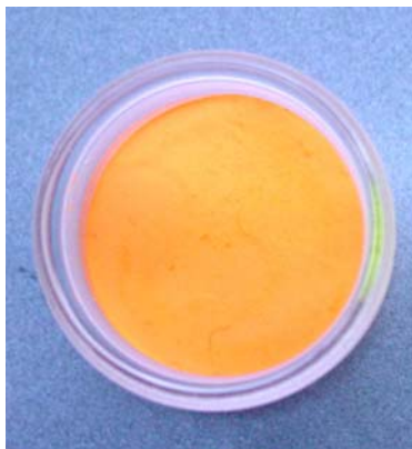
Abbildung 4-15: Fotografie einer mit 2.0 % \text{Eu}^{2+} dotierten Probe von \text{Sr}_2[\text{Si}_5\text{N}_8]:\text{Eu}^{2+} ; aufgenommen unter einer UV-Lampe.
