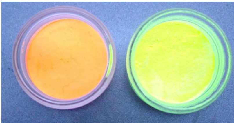
Abbildung 7—9: Fotografien von \text{Sr}_2[\text{Si}_5\text{N}_8]:\text{Eu}^{2+} (orange) und \text{Sr}[\text{Si}_2\text{O}_2\text{N}_2]:\text{Eu}^{2+} (grün) aufgenommen unter UV-Licht (254 nm).
