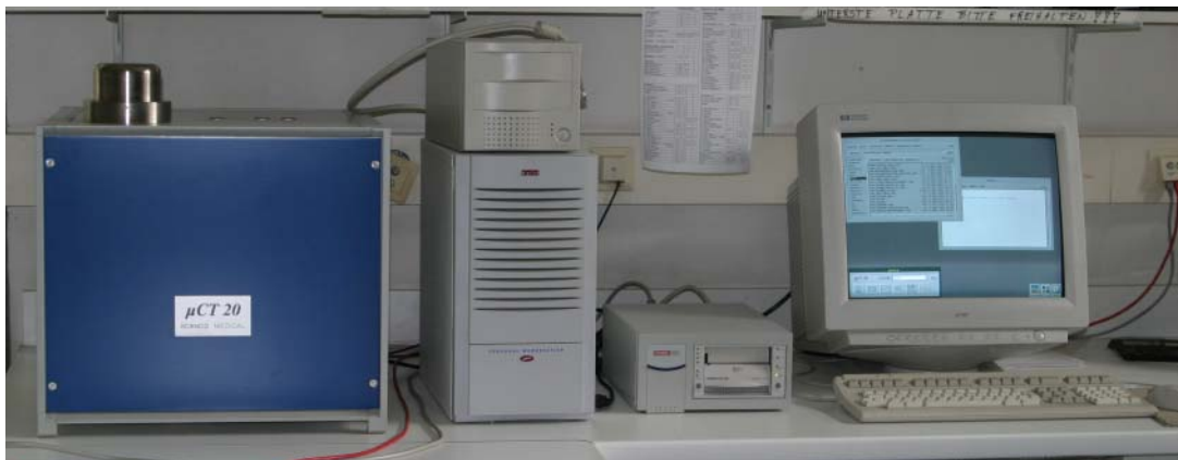
Abb. 3: Micro-CT 20 der Firma Scanco
