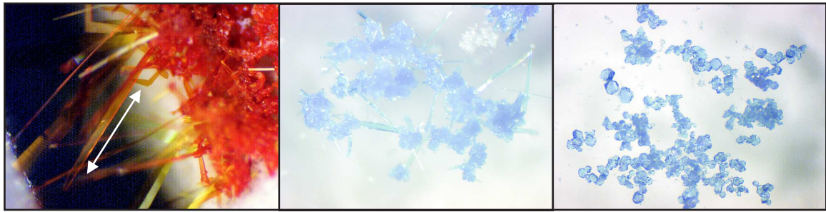
Abbildung 7.29: Kristalle von \text{Ce}_{10}[\text{Si}_{10}\text{O}_9\text{N}_{17}]\text{Br} (links), \text{Nd}_{10}[\text{Si}_{10}\text{O}_9\text{N}_{17}]\text{Br} (Mitte) und \text{Nd}_{10}[\text{Si}_{10}\text{O}_9\text{N}_{17}]\text{Cl} (rechts). Der weiße Pfeil misst ca. 1 mm.
