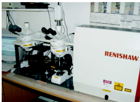
Abbildung 3.7: Raman-Spektrometer am Institut für Mineralogie der J.-W. Goethe Universität Frankfurt mit Mikroskop und Halterung zur Aufnahme einer Diamantstempelzelle.
