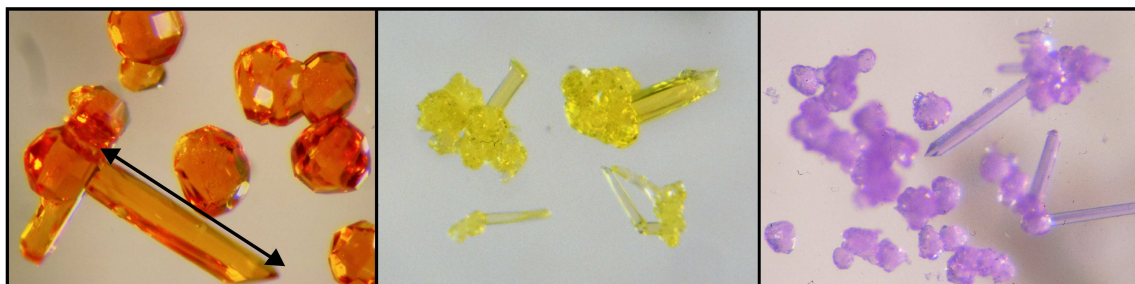
Abbildung 7.1: Kristalle von Ln_4[Si_4O_{3+x}N_{7-x}]Cl_{1-x}O_x mit Ln = Ce (links), Pr (mitte), Nd (rechts); Maßstab: der schwarze Pfeil misst ca. 0,45 mm.
