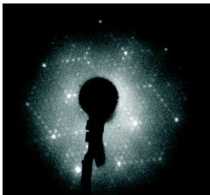
**Abbildung 6.8:** LEED Bild einer sauberen  $\text{Si}(111)(7 \times 7)$
