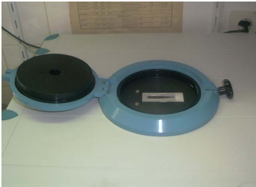
Abbildung 21: Foto der Flusszelle des PASA-Prototyps
