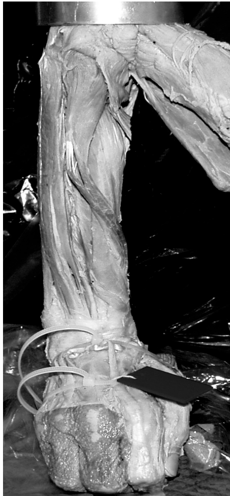
Abbildung 4: Mechanische Testung des Unterarms mit intakter Hand, intaktem Handgelenk, intakter Membrana interossea und intaktem Ellbogengelenk, zur Simulation des Krafttransfers bei einem Sturz auf die ausgestreckte Hand
