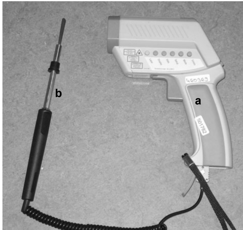
Abbildung 4: a=Infrarotoberflächenthermometer Amir 7814-20S; b=dazugehöriger Oberflächenfühler
