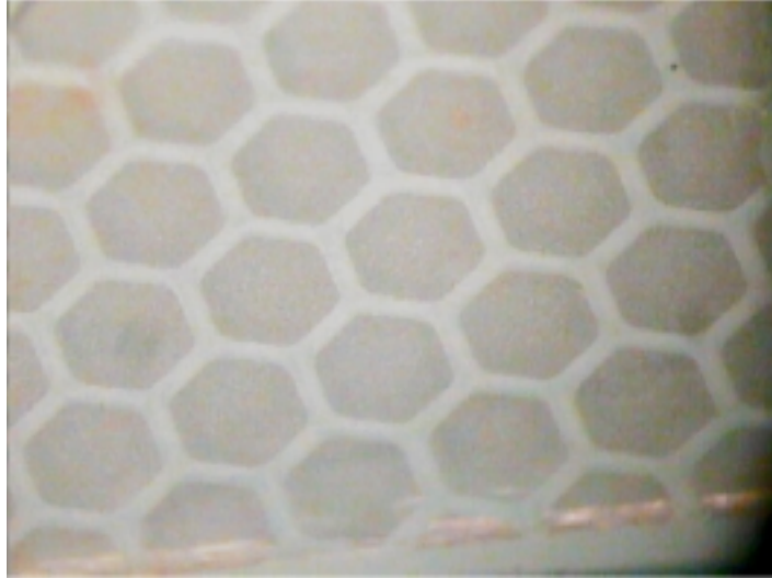
Abbildung 2.19: Ionenspurätzen als maskenlose Lithographie, hier Glasprobe, die durch eine bienenwabenhörmige Metallmaske hindurch mit hoher Fluenz bestrahlt wurde.
