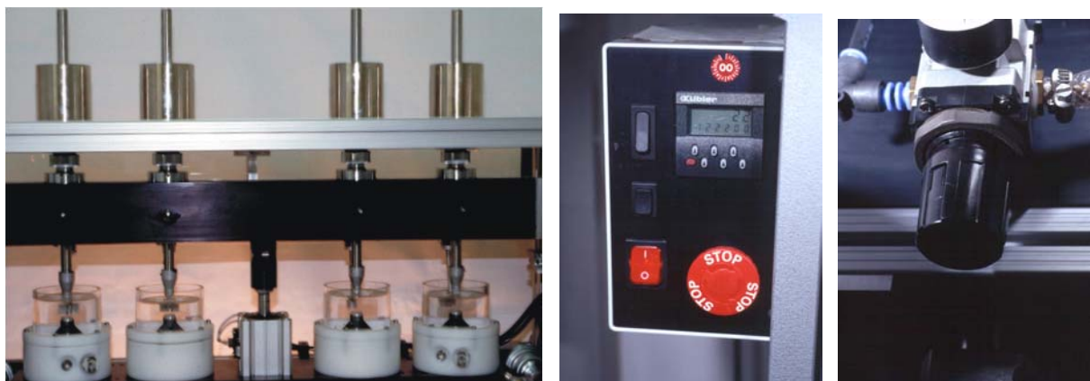
Abbildung 11: links Kausimulator München III, mitte Steuereinheit, rechts Druckluftventil zur Geschwindigkeitsregelung
