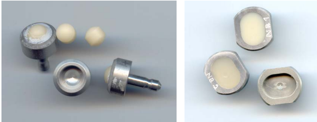
Abbildung 10: links Degussitkugeln, Probenträger und einpolymerisierte Antagonisten, rechts Probenträger und fertige Kompositprobe
