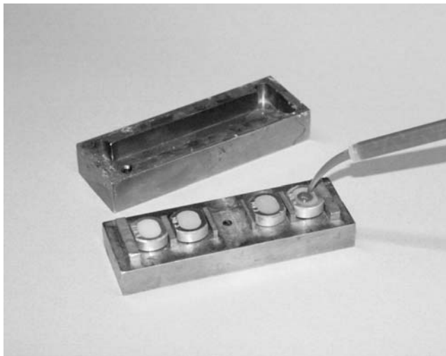
Abbildung 17: Abformung der Kompositproben mit Permadyne
