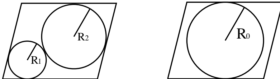
Abbildung 2: Skizze der Geometrie eines APW-Verfahrens. Links der allgemeine Fall mit mehreren APW-Kugeln je Einheitszelle, rechts der Spezialfall, daß nur eine Kugel im Zentrum sitzt.
