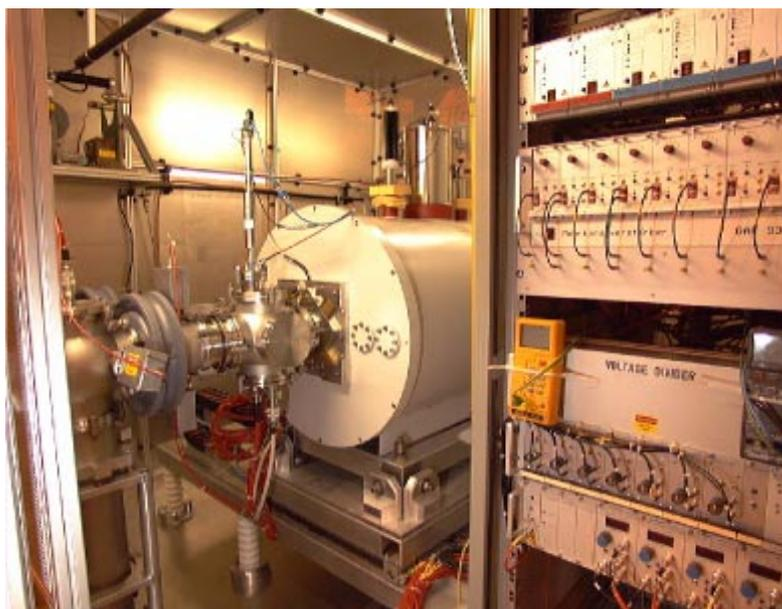
Abb. 3.1.1.3: Photo der REXTRAP im Hochspannungskäfig.
