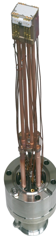
Abb. 4.6: Mikrofallensubstrat mit Halterung und elektrischen Kontakten
