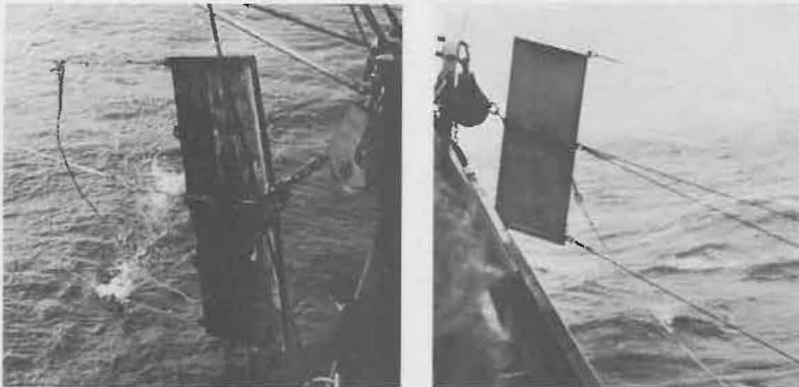
Abb.2: Seitenscherbretter nach Süberkrüb in Eisen- (rechts) und kombinierter Eisen-Holz-Bauweise (links). Die vom Netz kommenden Ständer sind an der Achterkante angeschlagen. Bei dem linken Brett sind Headleinen- und Grundtauständer in der üblichen Weise mit Ochsenauge, Zwischenständer, Quetschglied und G-Haken versehen und werden zusammen auf die Windentrommel gehievt.
