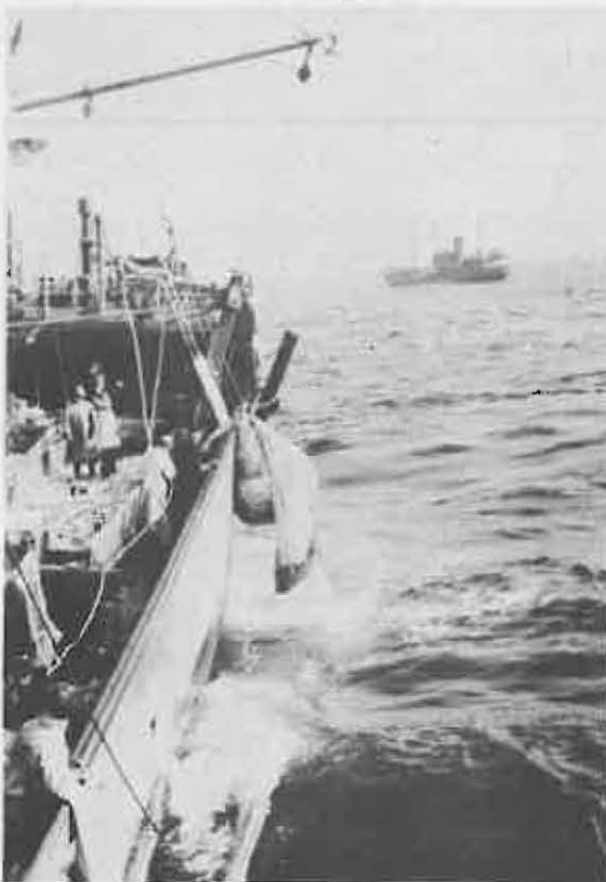
Abb.19: Größere Fänge werden auf Seitentrawlern in der üblichen Weise durch Teilen an Bord genommen. Beachte den im Vergleich zu den Heringsgrundschnepnetzen sehr viel dünneren Strang des leichten Schwimmschnepnetzes.
