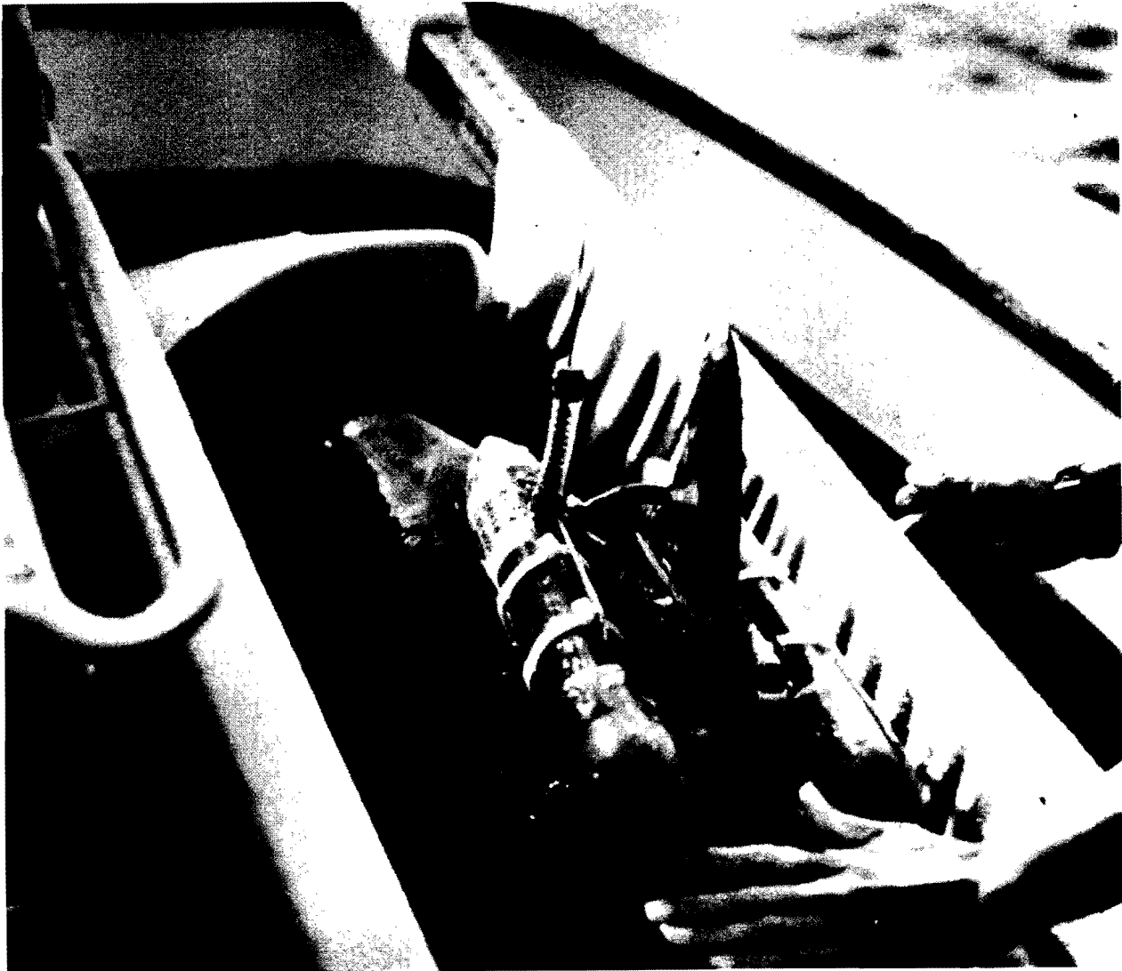
FIGURA A-19. Un radiotransmisor que funciona con satélite, recientemente fabricado para ser implantado en ballenas pequeñas y delfines. (Foto por J. Jennings, cortesía del NMFS).
