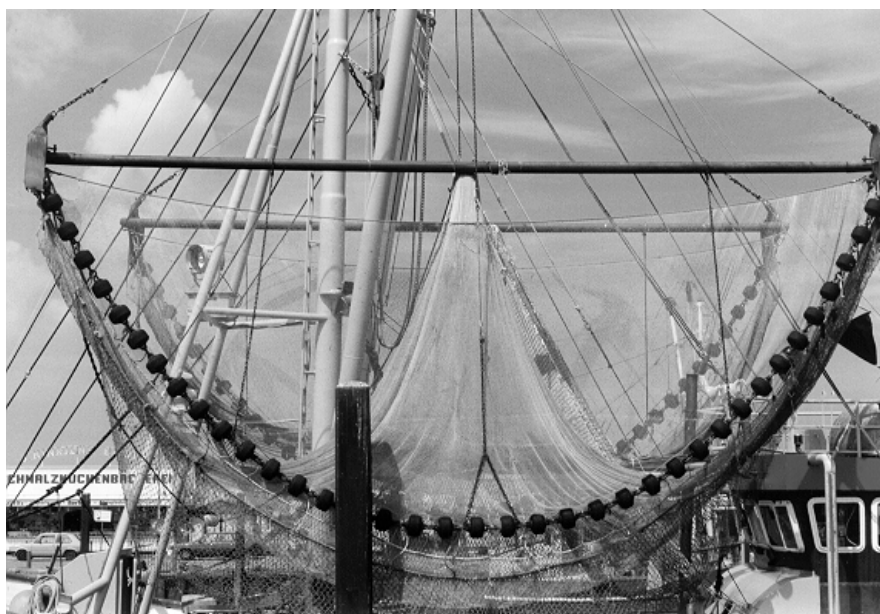
Abb. 1: Garnelenbaumkurre mit konventionellem Rigg des Gummrollengeschirrs
