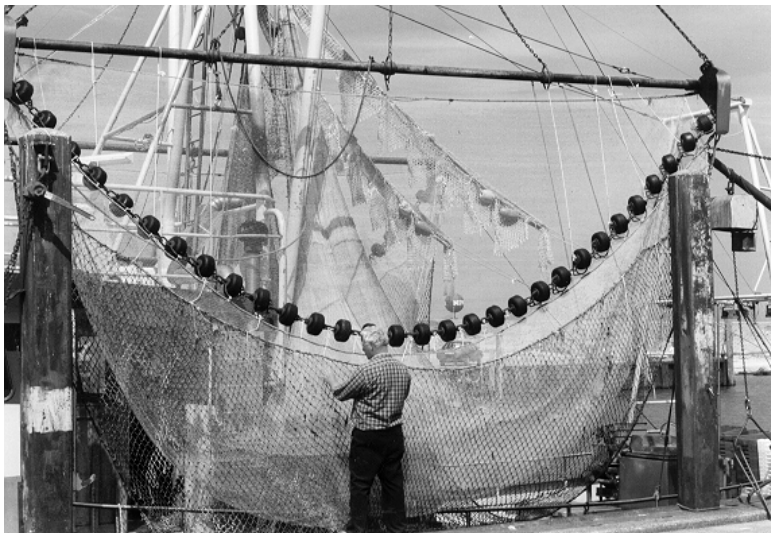
Abb. 3: Garnelenbaumkurre mit modifiziertem Rigg des Gummirollengeschirrs
